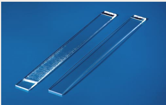
Linker Stab Plexiglas®: Sichtbare Spannungs- rissbildung durch herkömmliche Gleitmittel
